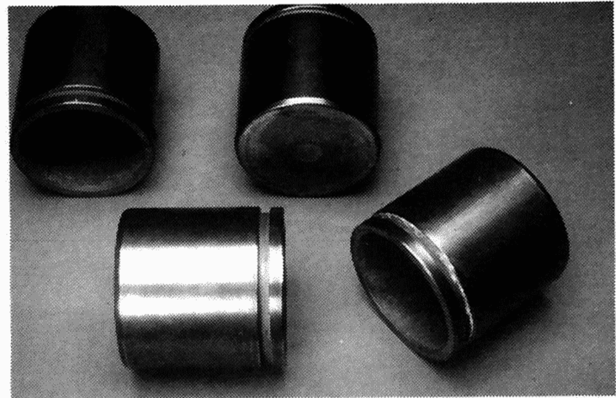
ディスクブレーキのピストン 目的：耐摩耗性，防錆性向上，工程簡素化 ナイトロテック-S処理
